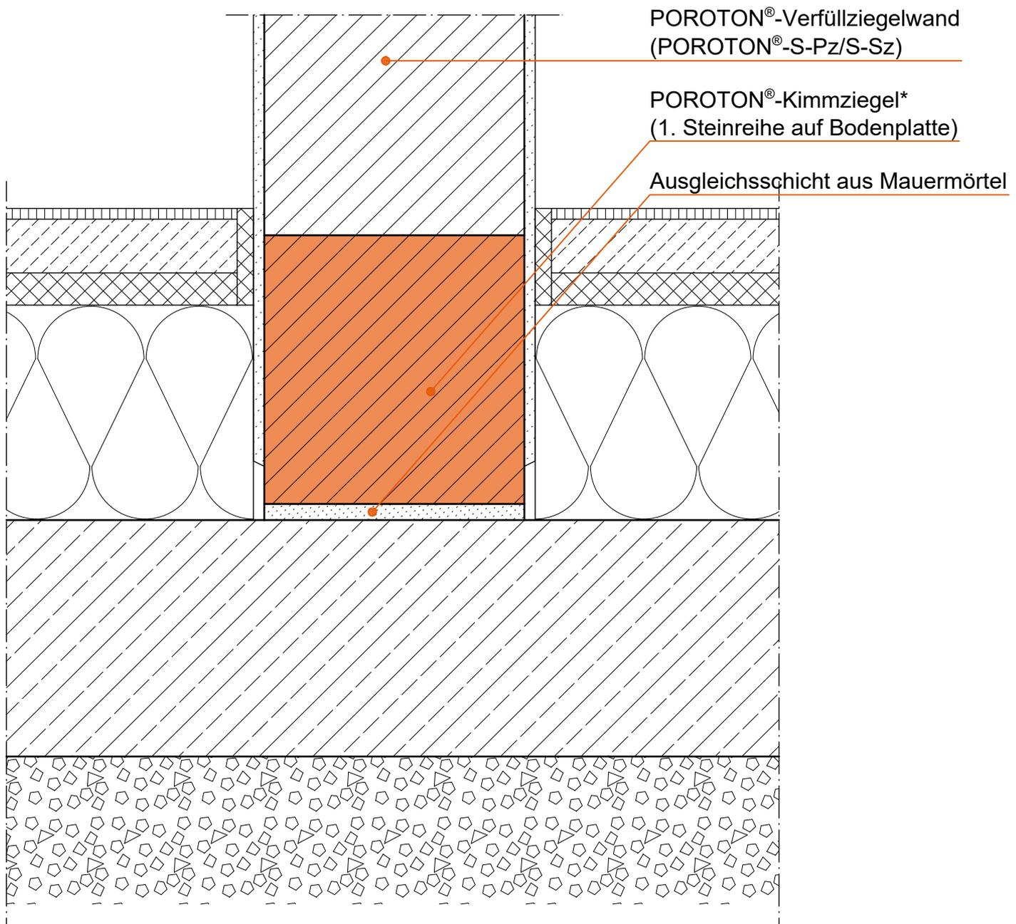
**\*) Um die schalldämmenden Eigenschaften der Wand nicht zu beeinträchtigen, muss die Kimmlage innerhalb des Bodenaufbaus unter OK Estrich liegen.**
