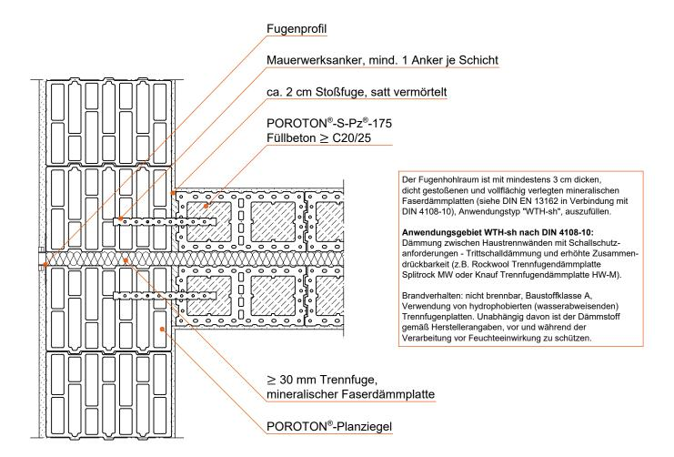
Die schallbrückenfreie Trennfuge zwischen den beiden Schalen muss vom Fundament bis zum Dach ohne Unterbrechung über die ganze Haustiefe und -höhe durchgehen. Auf eine besonders sorgfältige Ausbildung der Trennfuge ist zu achten.
