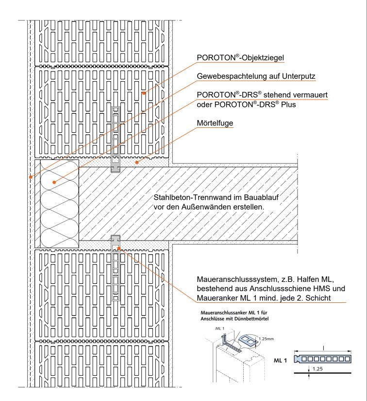
Für Wandstärken d > 36,5 cm kann ggf. eine Zusatzdämmung ≤ WLG 035 zwischen DRS® und Trennwand eingelegt werden.
