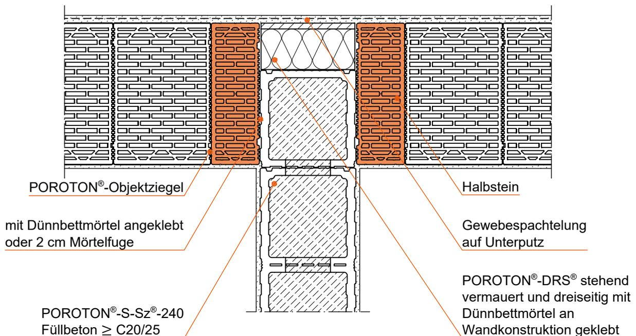
Für Wandstärken  $d > 36,5$  cm kann ggf. eine Zusatzdämmung  $\leq$  WLK 035 zwischen DRS® und Trennwand eingelegt werden.
